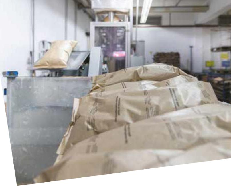
Die 2005 in Betrieb genommene Packkissenanlage verarbeitet die im Unternehmen anfallenden Kartonagen in einer Schredder- und Schlauchbeutelmaschine zu Füllmaterial für unsere Produktverpackungen. So können Ressourcen geschont und Emissionen bei der Entsorgung der Kartonagenabfälle sowie der Herstellung und Anlieferung von Zukaufmaterial gespart werden.
