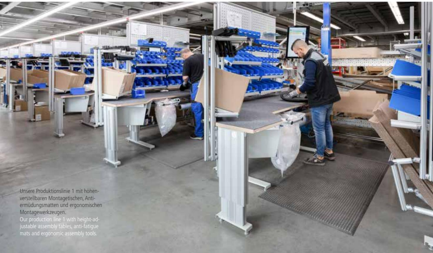
Unsere Produktionslinie 1 mit höhenverstellbaren Montagetischen, Antiermüdungsmatten und ergonomischen Montagewerkzeugen. Our production line 1 with height-adjustable assembly tables, anti-fatigue mats and ergonomic assembly tools.
